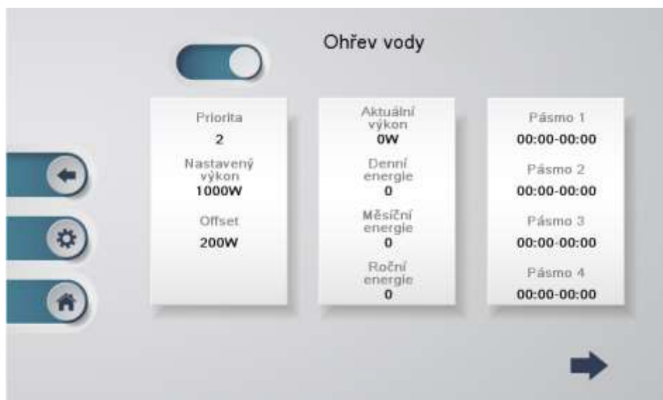
Obr. 14 - ukázka nastavení a stavů u zátěže Ohřev vody
